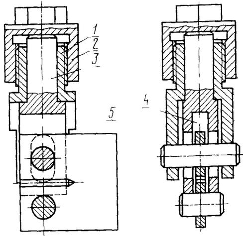
1 — винт; 2 — гайка; 3 — шток; 4 — продольный паз;
