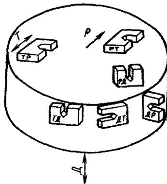
Направление вырезки: Д — долевое, вдоль главного вектора деформации;
